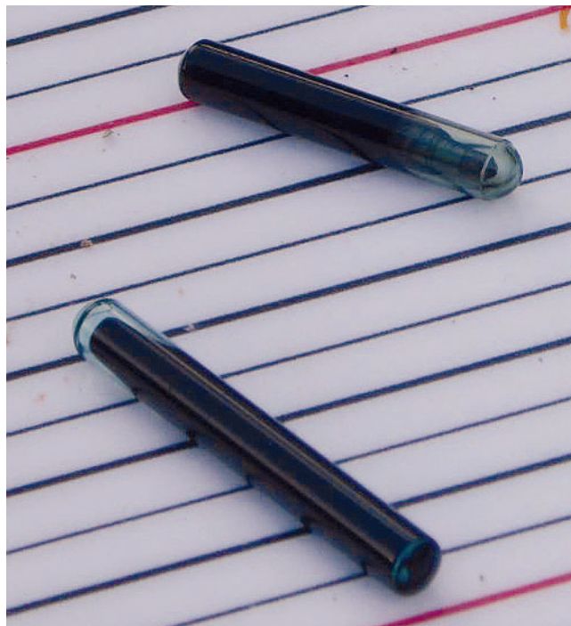
Verwendete Sender zur individuellen Markierung der Fische
